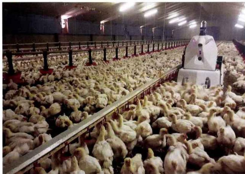
Robot Octopus Scarifier, gérant les sols des élevages de volailles.
