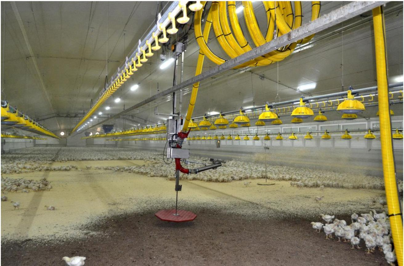
Le bras de distribution projette la paille sur l'intégralité du sol grâce à sa mobilité sur trois axes. Le rail lui permet de traverser le bâtiment dans sa longueur. Il balaye de gauche à droite grâce à un pivot central et un vérin lui permet d'envoyer la litière plus ou moins loin. © Dussau
