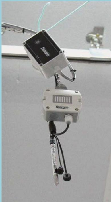
→ Un luxmètre mesure l'intensité de lumière naturelle au centre du poulailler.
